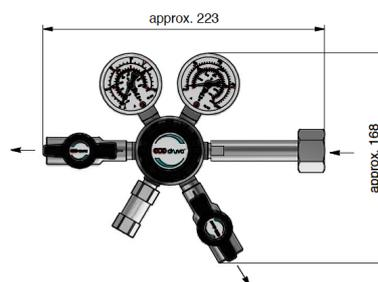
Option-**PR**: mit Hochdruck Spülventil & Niederdruck Regulierventil
