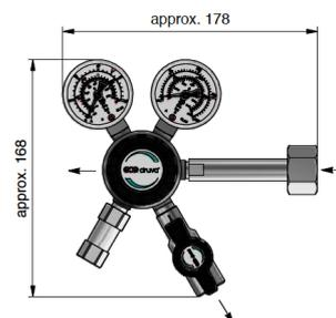
Option-**PS**: mit Hochdruck Spülventil & Niederdruck Absperrventil
